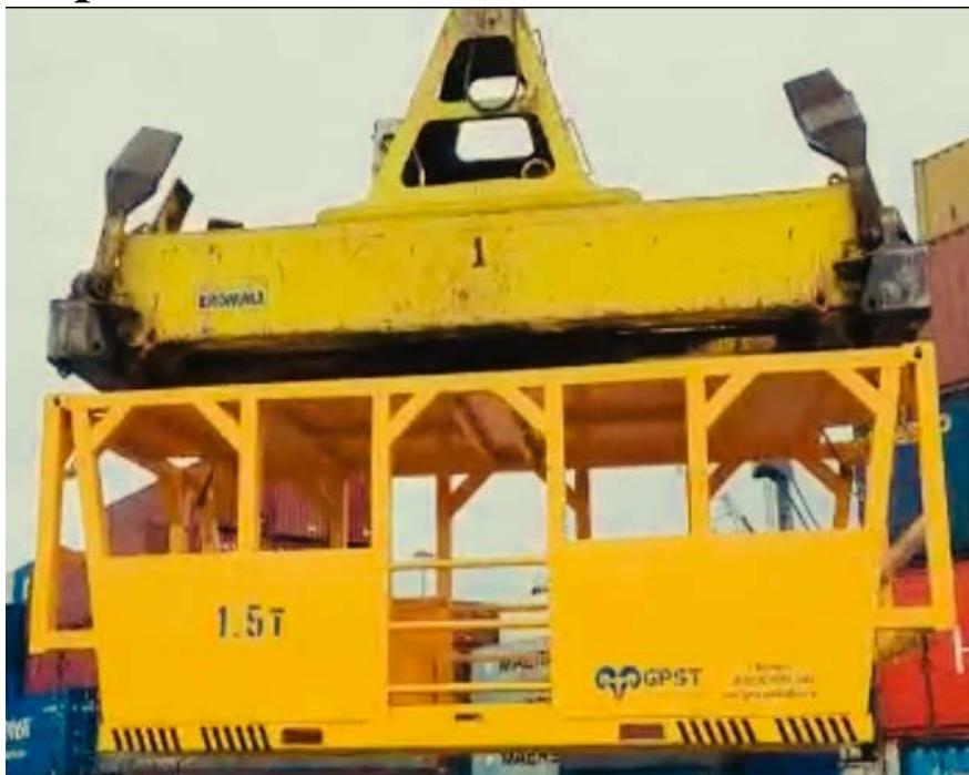
**Кабина предназначена для крепления и раскрепления контейнеров на судах, либо других работ.** Перемещаются кабины контейнерными перегружателями или мобильными кранами, оснащенными автоматическими спредерами. Количество докеров-механизаторов, перемещаемых в кабине, составляет 4-8 человека.
